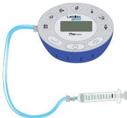
Slika 14. Prikaz spajanja šprice na senzor uređaja
