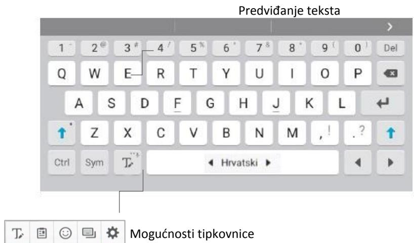
**Slika 16 - Zaslonska tipkovnica tablet računala**
